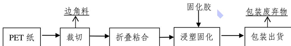
图 3.2 折纸滤芯生产工艺流程
